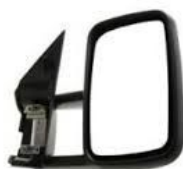
M.BENZ Sprinter 95/06 der+izq, largo, manual, vidrio convexo
